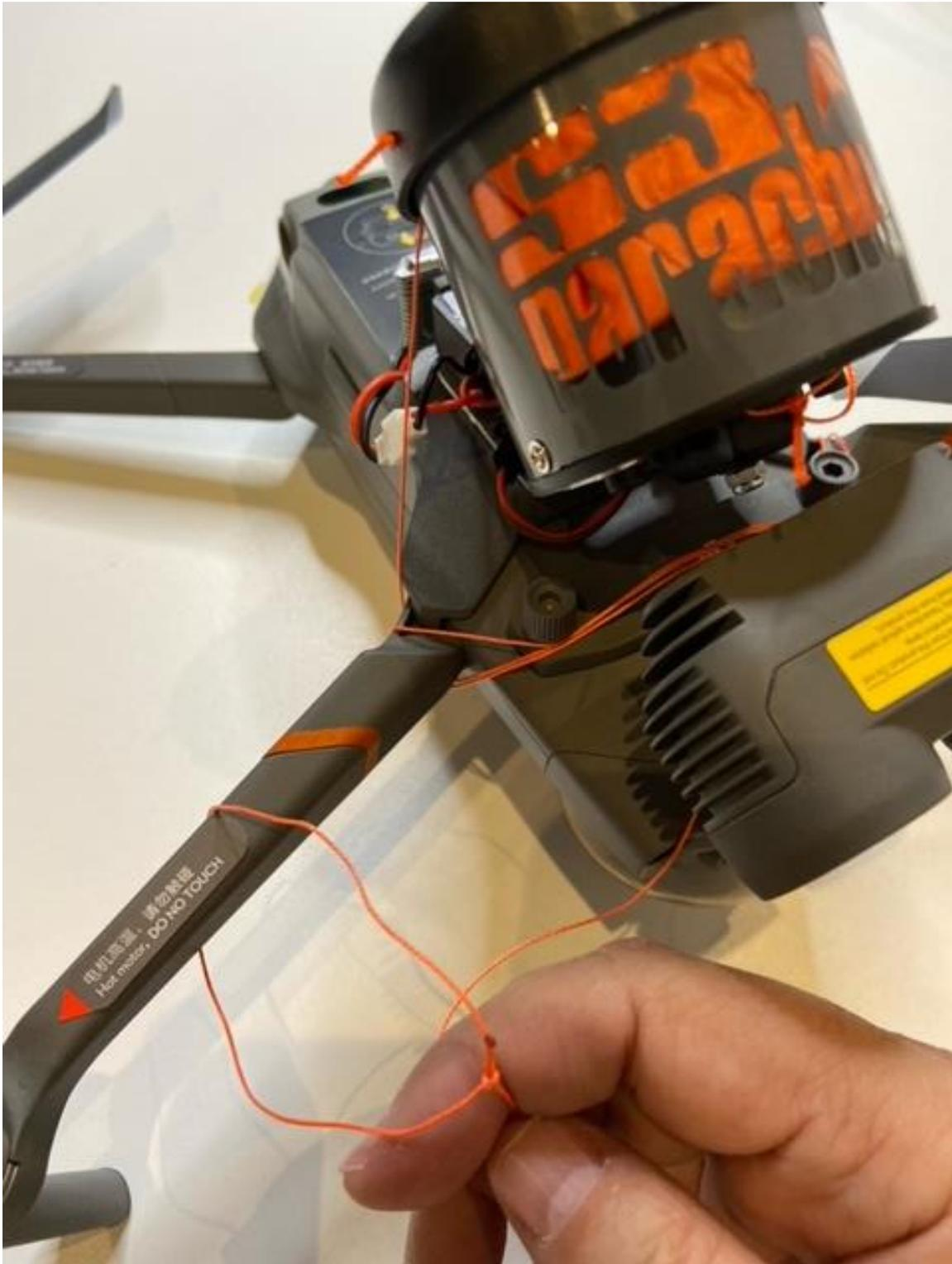
Posteriormente, se recoge el cordón restante y lo dejamos metido dentro del cilindro del paracaídas
